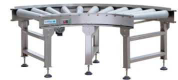
RCY90/D 90Degree Turn Roller Conveyor 90度动力旋转输送台 Conveyor Width/有效宽度: 520mm Conveyor Length/输送台长度: 1320mm C.V Height/台面高度: 650mm or 850mm Option Stainless Steel Body 可选不锈钢材质
