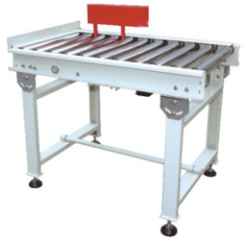
RC1M/90D 90Degree Push Roller Conveyor 90度动力转角输送台 Conveyor Width/有效宽度: 520mm Conveyor Length/输送台长度: 1050mm C.V Height/台面高度: 650mm or 850mm Option Stainless Steel Body 可选不锈钢材质
